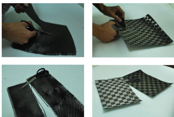
Рисунок 2. Удобство раскроя и выкладки. Слева саржа 200 г/м 2 , справа ткань Аспро 80 г/м 2 .
