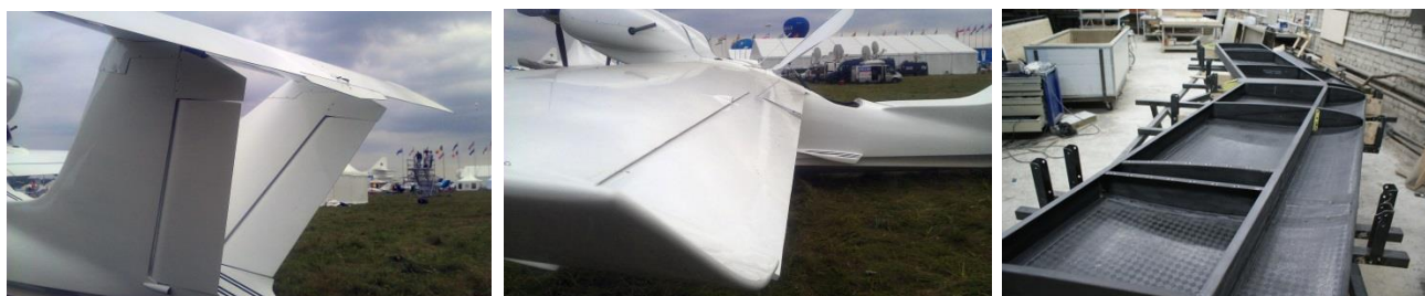
Рисунок 7. Элероны, стабилизатор, рули высоты и направления самолета Л-42м сделаны с применением тканей Аспро 80 г/м 2 . Справа – стабилизатор экраноплана «Иволга» на этапе сборки на стапеле.
