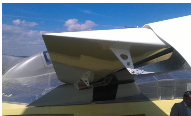
Рисунок 5. Экраноплан «Иволга». Элерон выполнен с применением ткани Аспро 80 г/м 2 .
